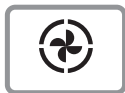
Hot air/ convection โปรแกรมนอบร้อนหมุนเวียน
