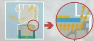
سوپاپ یک طرفه داخل کلاهک به گونه‌ای نصب شده که با افزایش فشار گاز های تولید شده در داخل چاه فاضلاب و برای چند ثانیه باز شده تا این گازها خارج گردد. از اینرو همواره هوای اطراف کولرها در پشت بام منازل را آلوده ننموده و مانع از انتشار بوی نامطبوع در داخل ساختمان می گردد.
